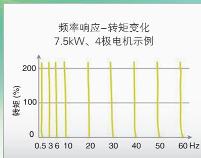
由于MX2具备近乎静止(0.5Hz)的200%起动转矩，并且可在开环模式下实现转矩控制操作，因而也可以用于以前使用闭环矢量控制的一些场合。
