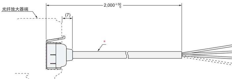
\* 导线  $\phi 4/3$ 芯/标准2m(导体截面积: 0.2mm<sup>2</sup>(AWG24)/绝缘体直径:  $\phi 1.1$ mm)
