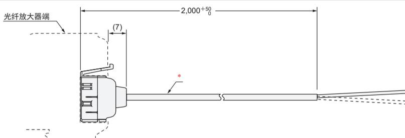
\* 导线  $\phi 2.6/1$ 芯/标准2m(导体截面积: 0.2mm<sup>2</sup>(AWG24)/绝缘体直径:  $\phi 1.1$ mm)
