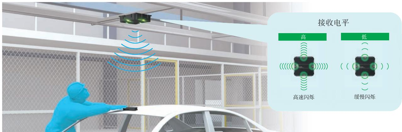
一边观察读写器的LED，一边调整RF标签的安装位置，以提高接收电平
