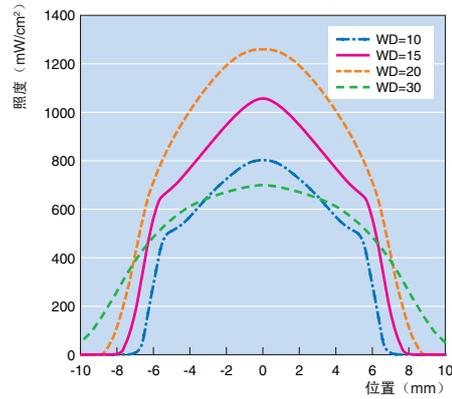
线光束透镜 ZUV-L12L 照度轮廓 (宽度方向)
