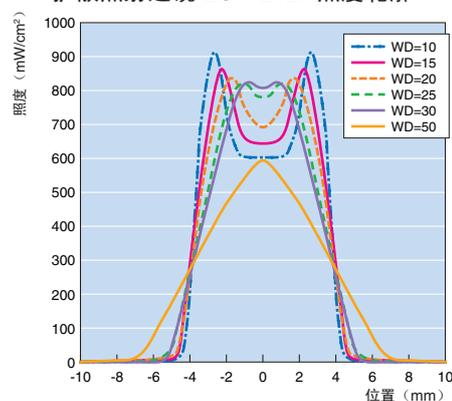
线光束透镜 ZUV-L15L 照度轮廓 (长度方向)
