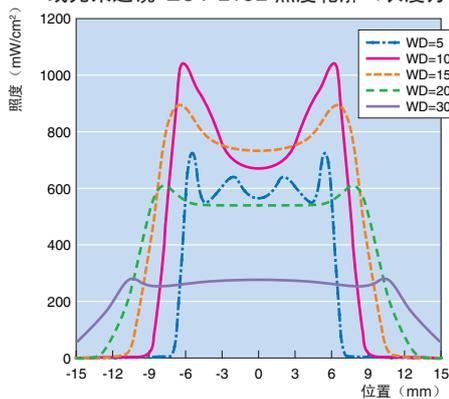
线光束透镜 ZUV-L15L 照度轮廓 (宽度方向)
