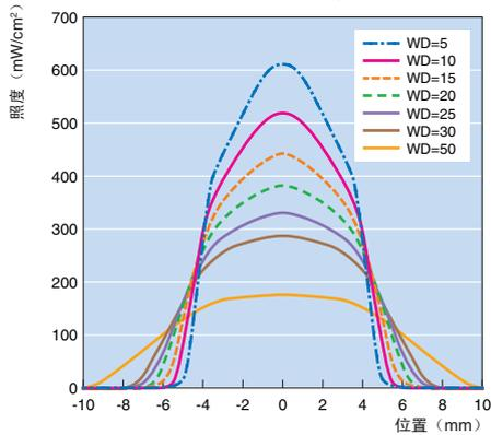
线光束透镜 ZUV-L12L 照度轮廓 (长度方向)
