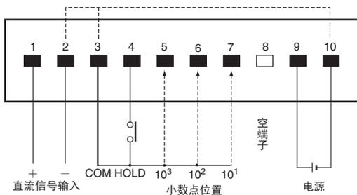
注：2-3-10之间内部未作绝缘处理，因此控制电源请尽量使用同其他设备绝缘的、单独的电源。外部控制请尽可能用接点高度可靠的继电器（最小负载电流0.3mA以下）和光电耦合器（残留电压1V以下、泄漏电流0.1mA以下）等，予以绝缘。
