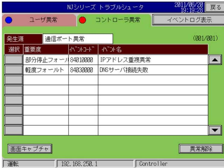
要解除控制器异常时，需要依据故障诊断器设定的操作权限限制进行认证。
