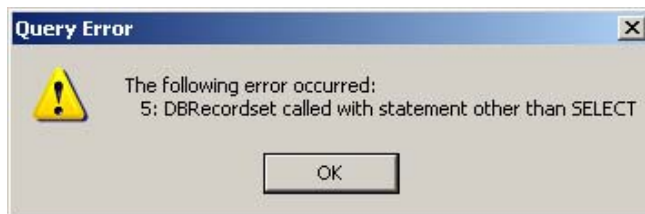
图65: 未作为Omron Microscan管理员登录软件时的请求错误信息示例
