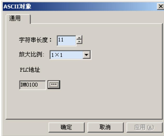
在 PLC 中，设置通道 DM0100 值为 0x4041，DM0101 值为 0x4243，DM0102 值为 0x4445，DM0103 值为 0x4647，DM0104 值为 0x4849，DM0105 值为 0x4A4B。则按 MPT002 按通道内所放置的 ASCII 码显示如下。
