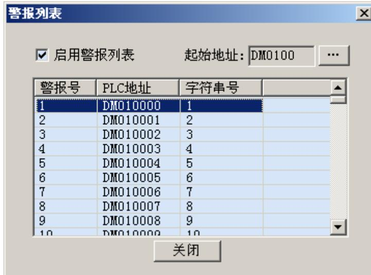
在报警列表中，用户可以选择启用报警列表，同时为报警号分配对应的 PLC 通道地址，字符串号表示一旦该报警号产生报警，则显示相应字符串号的内容。若用户在设置报警列表时设置“字符串号”为 0，则表示该报警项不启用。
